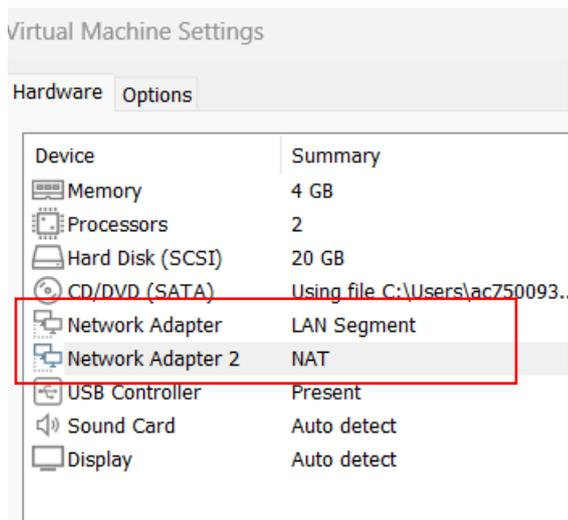
Voilà vous avez maintenant deux carte réseaux une pour le réseaux interne qui va va être utilisé par notre DHCP sur le poste Clients et l'autre en NAT qui va nous fournir une connexion pour installer le rôle DHCP sur notre machine
