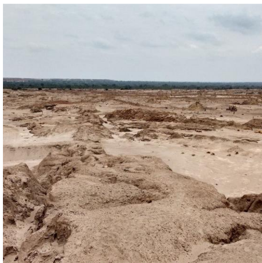
instalação de armazenamento de rejeitos >4.000 ppm Cu
