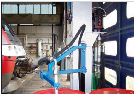
Bombas de pistón de 2 esferas con una relación 9:1 utilizadas en un proceso de lubricación personalizado
