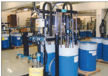
Bombas de extrusión con una relación 23:1 utilizadas en plataformas de varios componentes para transferir silicio
