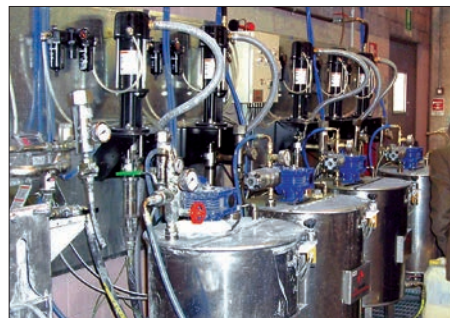
Bombas de pistón de 2 esferas con una relación 4:1 utilizadas en un proceso de producción de pintura
