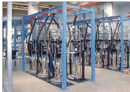
Bombas de pistón de 2 esferas con una relación 9:1 utilizadas en un proceso de lubricación personalizado
