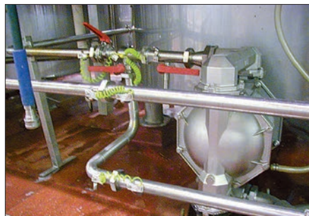
Bomba sanitaria de 3" (76,2 mm) utilizada para transferir productos cosméticos básicos para la producción de champú
