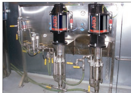
Bombas de pistón de 4 esferas con una relación 4:1 utilizadas en un proceso de formulación de pintura
