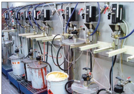
Bombas de pistón de 2 esferas con una relación 4:1 utilizadas en un proceso de producción de pintura
