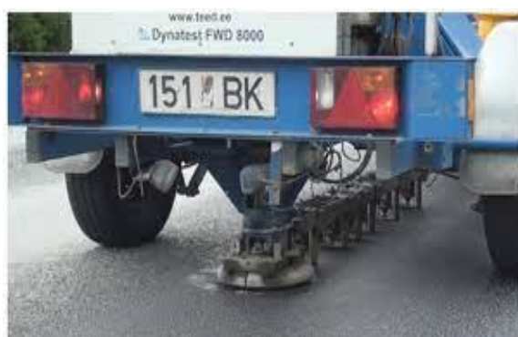
Figura 2 e 3 – Detalhes dos geofones do FWD 8000 Dynatest
