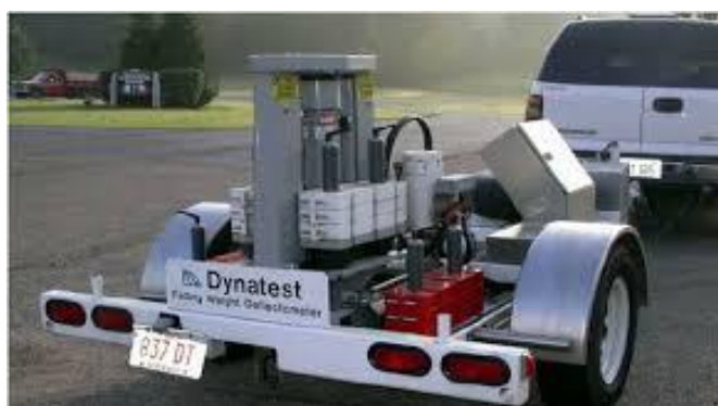
Figura 4 – FWD sendo rebocado por uma caminhonete
