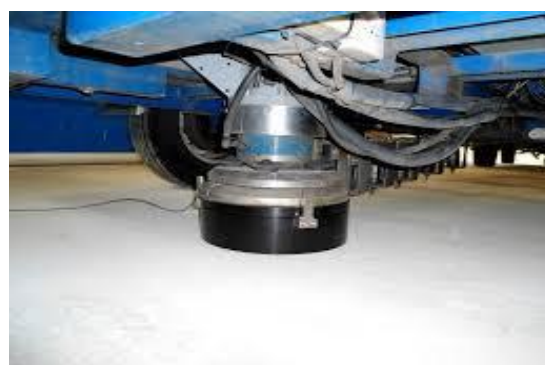
Figura 2 e 3 – Detalhes dos geofones do FWD 8000 Dynatest
