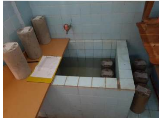
Gambar 4.5. Beton basah-kering diangkat dari bak menurut jadwal siklus
