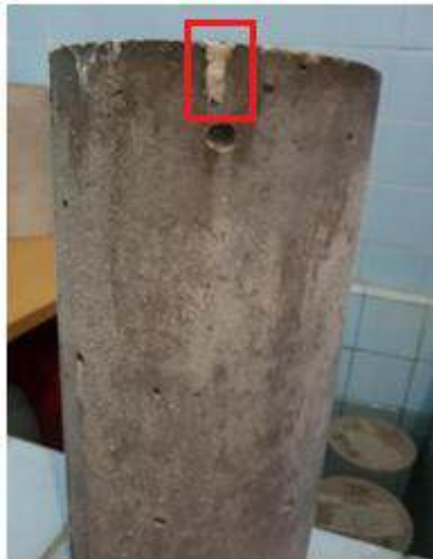
Gambar 4.6. Gumpalan putih pada dasar beton basah seterusnya
