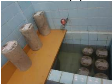
Gambar 4.4. Permodelan Variasi Paparan Air Laut
