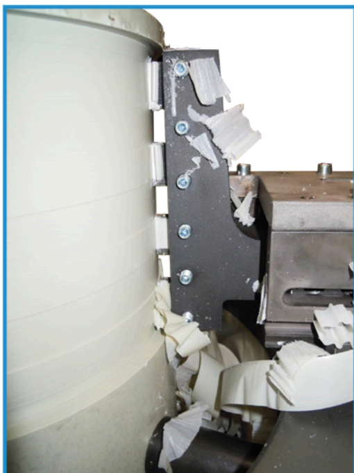
Máquina orbital de corte com opção de remoção do revestimento PROTEM TTNG-HD
