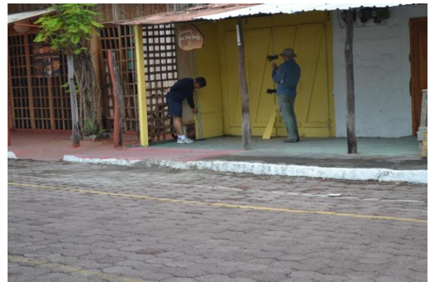
Figura 27 Medición del run-up realizada sobre una línea de marca de agua en la ciudad de Puerto Ayora-
