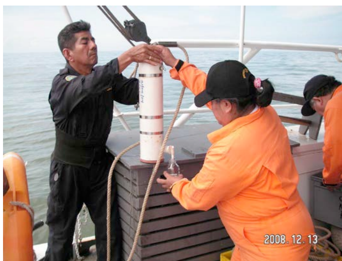
Figura 4.- Obteniéndose la muestra de agua de la botella Van Dorn para realizar el estudio de los parámetros químicos.
