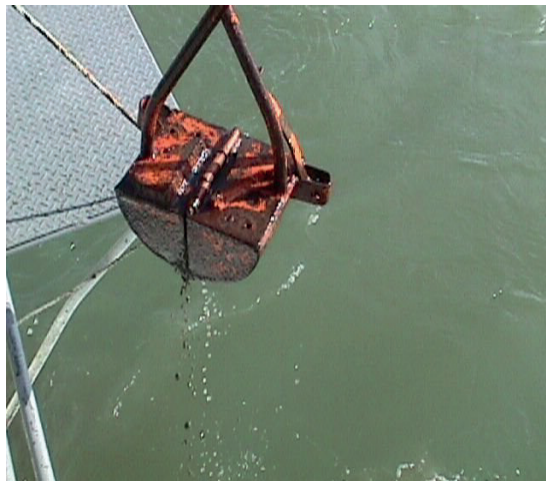
Fig. 2a.- Se observa la draga metálica tipo Van Veen de 1/20 m 2 para la obtención de los sustratos submareales o de profundidad.
