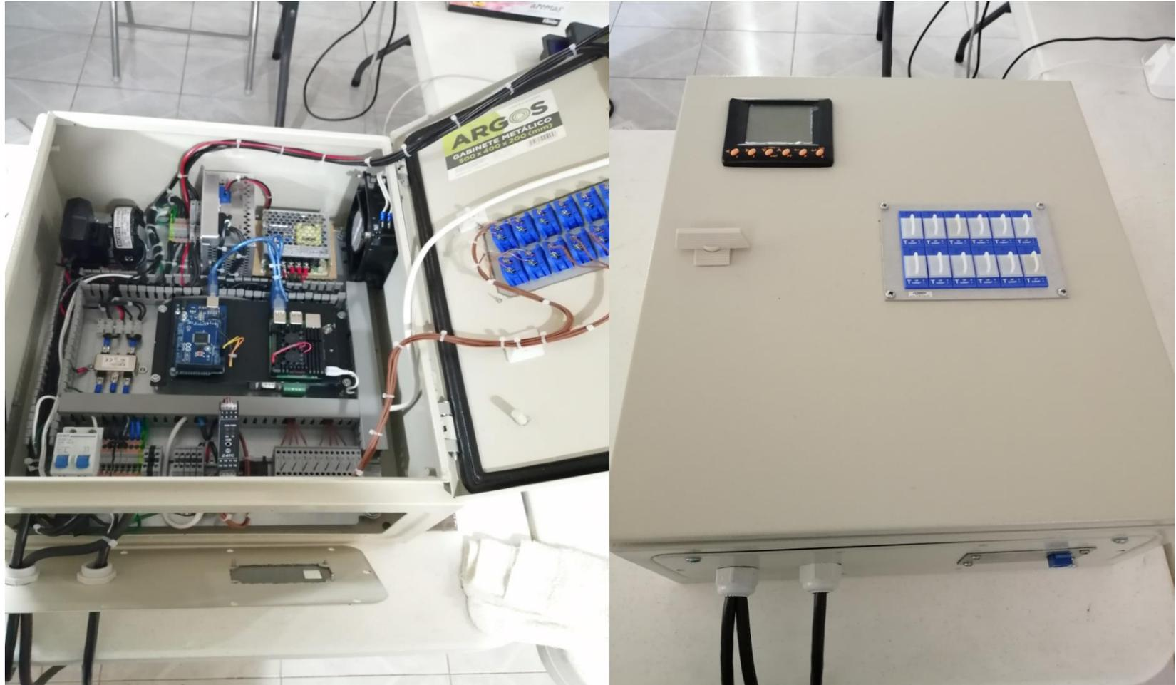
En este proyecto el sistema lee 8 temperaturas utilizando termopares tipo T y adicionalmente lee tres variables eléctricas: voltaje, corriente y factor de potencia del refrigerador.
