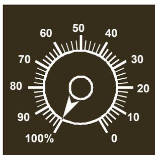
De fábrica, el punto cero está ajustado a una contrapresión de 3 bar. Si la contrapresión de funcionamiento en la válvula de salida se desvía considerablemente de dicho valor, se recomienda reajustar el punto cero para obtener valores más precisos.
