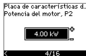
Establezca la potencia nominal del motor, P2, de acuerdo con la placa de características del motor:
