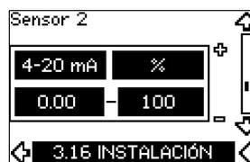
Ajuste del sensor 2 conectado a un módulo de entrada de sensor MCB 114.
