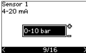
Ajuste el intervalo de medida del sensor conectado con un intervalo de señal de 4-20 mA. El intervalo de medida depende del modo de control seleccionado:
