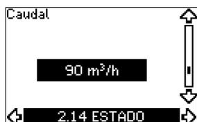
Esta pantalla sólo se muestra si se ha configurado un caudalímetro.
