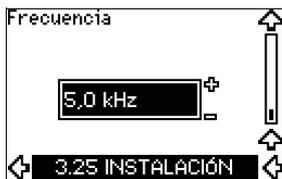
La frecuencia de conmutación puede cambiarse, las opciones en el menú dependen de la magnitud de la potencia del CUE. Al cambiar la frecuencia de conmutación a un nivel más elevado, se aumentarán las pérdidas y, de esta forma, se incrementará la temperatura del CUE.
