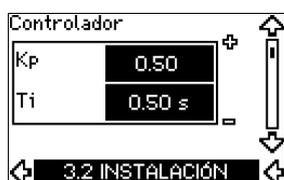
El CUE tiene un ajuste de fábrica de ganancia ( $K_p$ ) y tiempo integral ( $T_i$ ). Sin embargo, si el ajuste de fábrica no es el óptimo, en esta pantalla pueden cambiarse la ganancia y el tiempo integral.
