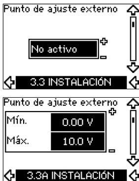
La entrada para la señal externa del punto de ajuste (terminal 53) puede ajustarse a los siguientes tipos:
