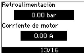
Se mostrará la presión durante la prueba si hay un sensor de presión conectado. Durante la prueba siempre se muestra la intensidad del motor.
