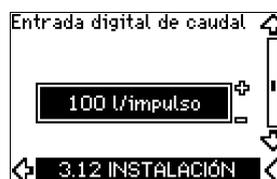
Esta pantalla sólo aparece si se ha configurado un caudalímetro en la pantalla 3.11.
