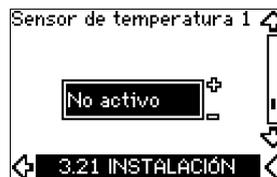
Esta pantalla sólo se muestra si se ha instalado un módulo de entrada de sensor MCB 114.
