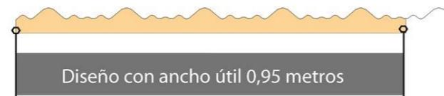
Diseño con ancho útil 0,95 metros
