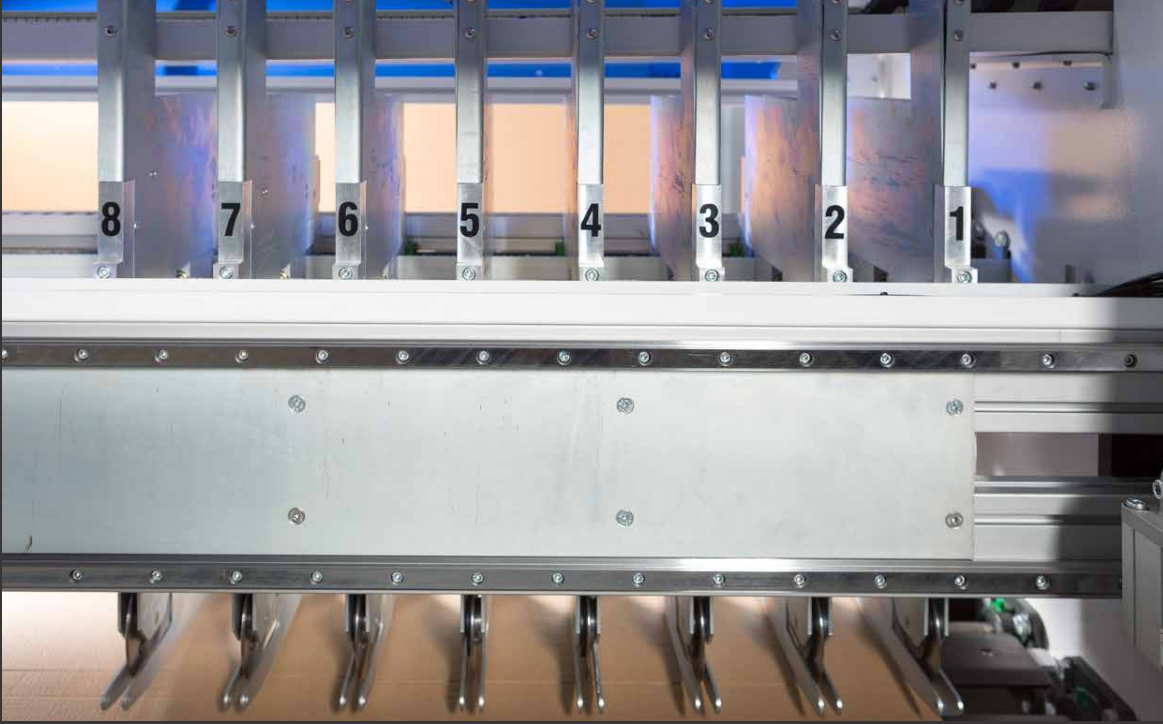
Dikeyde 8 Bıçak standart, 16 bıçağa kadar opsiyon 8 Blades standard in vertical, option up to 16 blades
