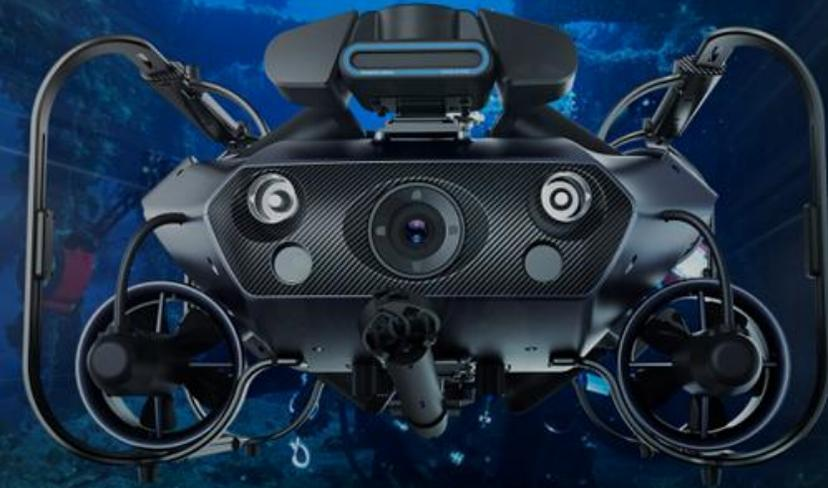
**Arreglo:** CHASING X, DVL, USBL, Brazo de agarre, sonda de imágenes multihaz
