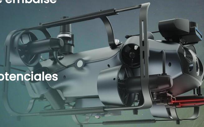
**Arreglo:** CHASING X, DVL, USBL, Sonar de imágenes multihaz, Escalador láser, e-PTZ
