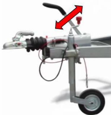
Rysunek 5. Zakres ruchu hamulca postojowego przyczepy
