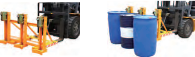
三桶夹具（一次夹 3 只桶，单夹爪，夹塑铁桶）
