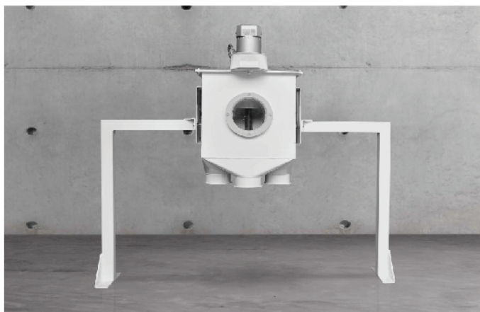
Phân lượng phân chia nguyên liệu dạng hạt, bột thành nhiều ngã đi khác nhau. To distribute granular and powder materials into different directions/ways.
