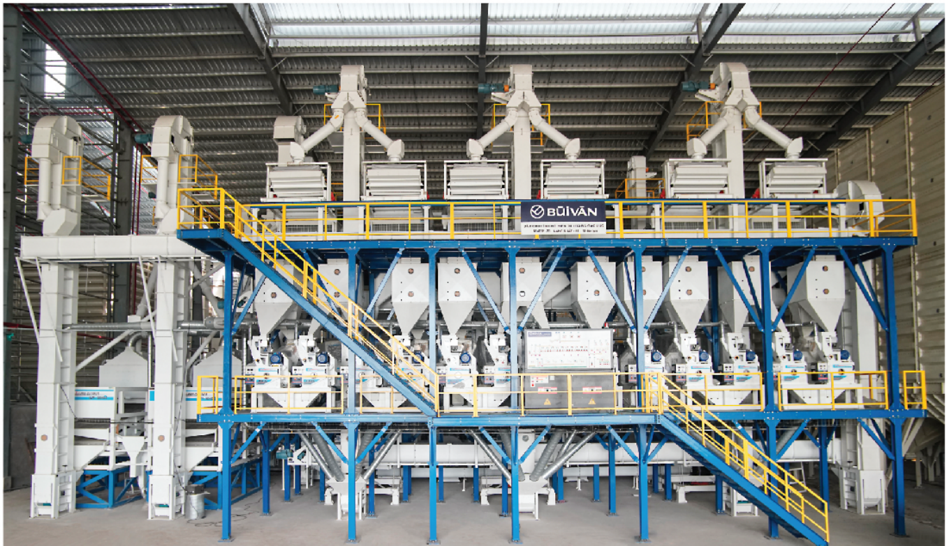
Dây chuyền chế biến từ lúa ra gạo lức - Năng suất: 24 - 40 tấn lúa/giờ Rice processing line from paddy to brown rice - Capacity: 24 - 40 ton on paddy/hour
