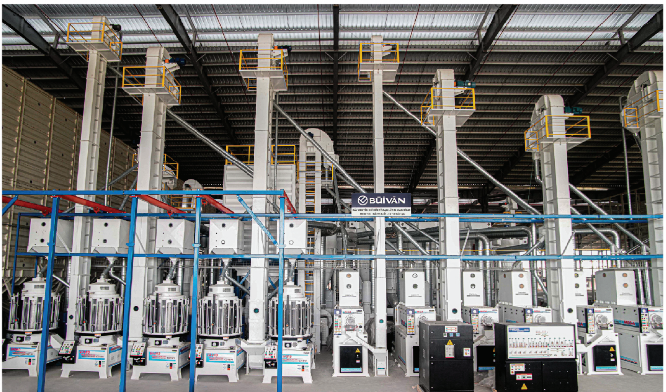
Dây chuyền chế biến từ gạo lức ra gạo bóng - Năng suất: 15 - 30 tấn lức/giờ Rice processing line from brown rice to polished rice - Capacity: 15 - 30 ton on brown rice/hour
