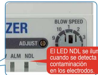
El LED NDL se ilumina cuando se detecta contaminación en los electrodos.
