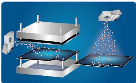
Evita el pegado de la pieza de trabajo en el molde de resina
