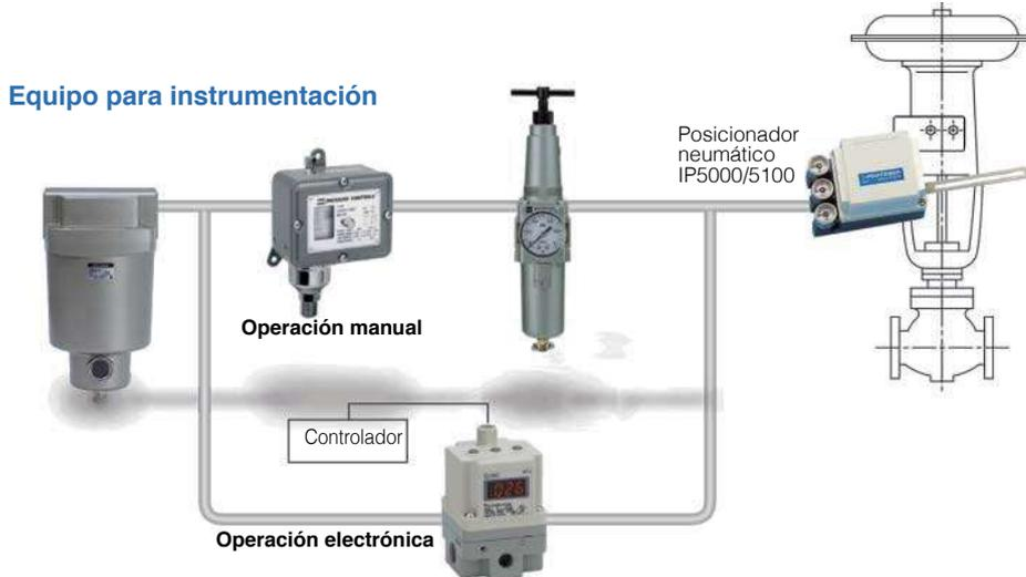
Control neumático de válvulas de mariposa en diversos procesos: desulfurización, refrigeración y tratamiento de aguas.
