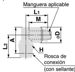
\* Dimensiones de referencia después de la instalación de un modelo de rosca R
