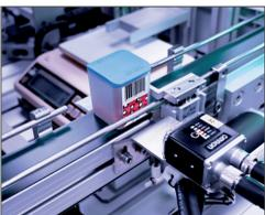
Un sistema de visión artificial para medir calcula las distancias entre dos o más puntos o ubicaciones geométricas en un objeto, y determina si estas medidas cumplen con las especificaciones.
