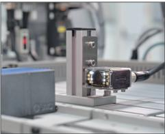
El guiado puede ser utilizado por diferentes motivos. Los sistemas de visión artificial permiten ubicar la posición y la orientación de una pieza para luego utilizar esta información en diversas partes del proceso de montaje, carga, empaque, posicionamiento...
