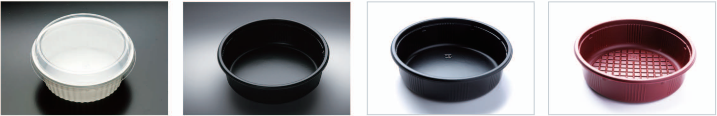
名称: 新丸容器-小 模具编号: RZ-114 制品尺寸: 盖D102×20身D99×34 纸箱尺寸: 盖640×550×640 克重: 盖1. 5g 身3. 15g 材质: 盖OPS 身PP 入箱数: 盖2000枚 身2000枚 名称: PP黑碗 模具编号: RZ-150 制品尺寸: D135×37 纸箱尺寸: 600×570×410 材质:PP 克重: 14. 8g 入箱数: 3000枚 名称: 单个小碗 模具编号: RZ-138 制品尺寸: D135*37 克重: 14g 材质: PPF 外箱: 575×445×535 入箱数: 1000枚 名称: 单个小碗 模具编号: RZ-138 制品尺寸: D135*37 克重: 14g 材质: PPF 外箱: 575×445×535 入箱数: 1000枚
