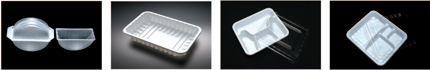
名称: PP米汉堡子母盒 模具编号: RZ-123 制品尺寸: 母110×46×50 子93×41. 5×44 克重: 母5. 5g 子5. 5g 材质:PP 克重: 29g 入箱数: 母2900枚 子2900枚 名称: 乳白PP盒 模具编号: RZ-135 制品尺寸: 247×153×40 纸箱尺寸: 620×400×600 材质:PP 克重: 29g 入箱数: 560枚 名称: 四格带盖盒 模具编号: RZ-149 制品尺寸: 盖224×192×19 身222×190×41 克重: 盖6g 身27g 材质: 盖OPS 身PPF 克重: 盖500枚 身500枚 名称: 餐盒RZR-06 模具编号: RZ0177 制品尺寸: 229×197×31 盖制品尺寸: 229X197X22 材质: 盖BOPS身PPF 克重: 28. 7g 克重: 7. 1g
