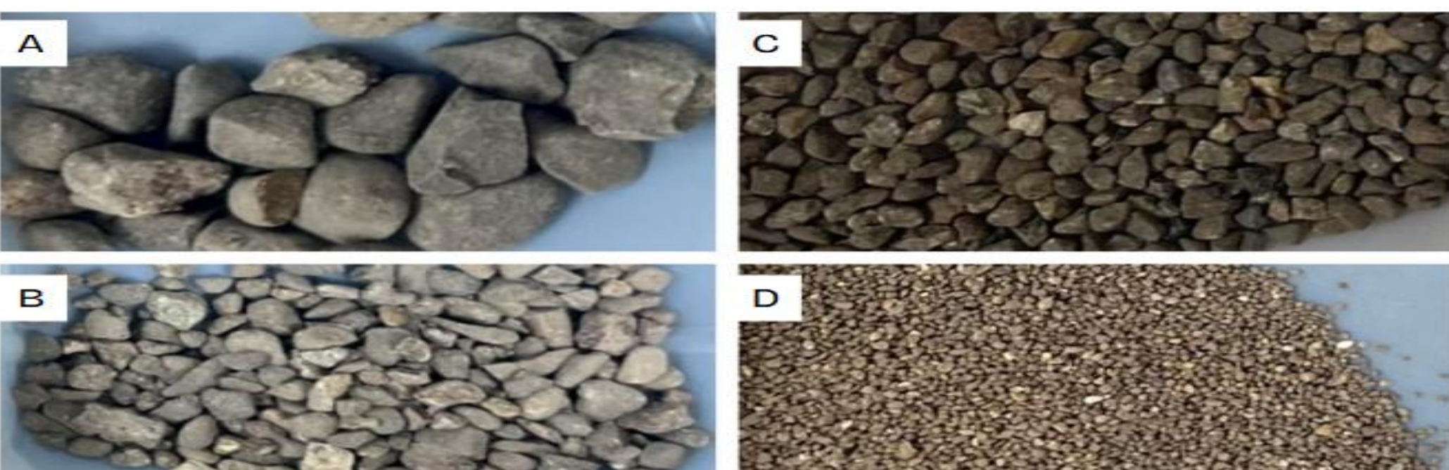
Figura 2. Fracciones granulométricas de partículas de grava: A) 4.75 mm, B) 2.00 mm, C) 1.00 mm, D) 0.5 mm. La grava gruesa se clasifica como particulado > 2 mm y la grava fina como particulado < 2 mm.
