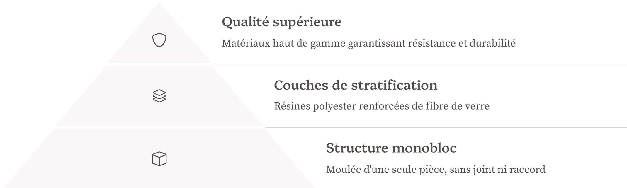
Chaque piscine est moulée d'une seule pièce, sans joint ni raccord, pour éviter les fuites d'eau dans le temps. Les couches de stratification comprennent des résines polyester renforcées de fibre de verre, une application soignée du gelcoat, et plusieurs couches de mat et renforts. Nos matériaux sont de qualité supérieure (résines utilisées dans l'aérospatial, nautique, etc.) garantissant résistance et durabilité.
