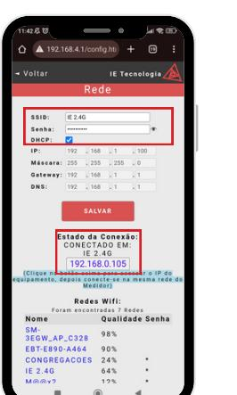
**PASSO 5:** O medidor irá reiniciar e o LED AZUL ficará ligado direto, indicando que o medidor conectou na REDE.
