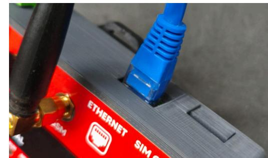
**PASSO 2:** Verificar se os Leds indicadores do conector de rede estão piscando, caso contrário verificar o cabeamento local e se persistir, entrar em contato com nosso suporte técnico.
