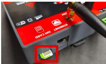
**PASSO 2:** Conecte a antena GSM 2g e certifique que esteja bem conectada, sem folgas na conexão.
