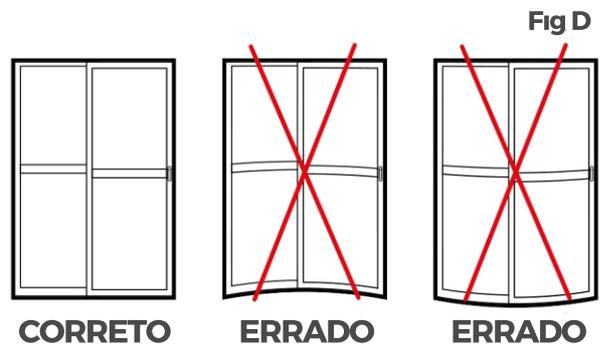
**OBSERVAÇÃO** No processo de instalação, verificar se os trilhos e laterais não estão abaulados ou fora de alinhamento conforme fig. D, para isso NÃO calçar os trilhos superior e inferior na parte central, pois pode causar o empenamento travando as folhas móveis prejudicando o fechamento ideal para o produto. • correto é calçar apenas nas laterais.
