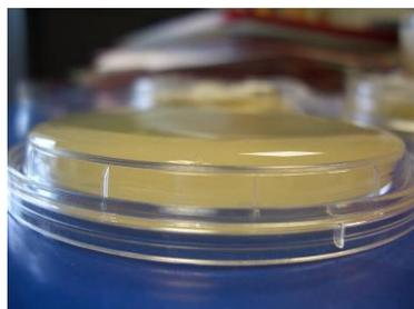
Figure 16 : Photo du « profil convexe » d'une boîte contact non ensemencée
