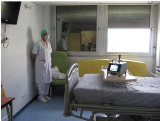
**Figure 7 : Exemple de position du préleveur quand il ne peut pas sortir de la salle dans une chambre en environnement maîtrisé**
