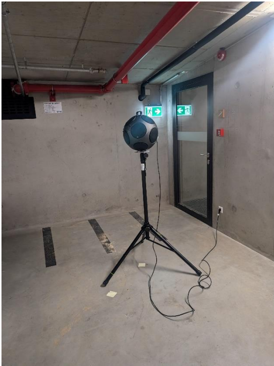
Photo 1: Source de bruit normalisée
