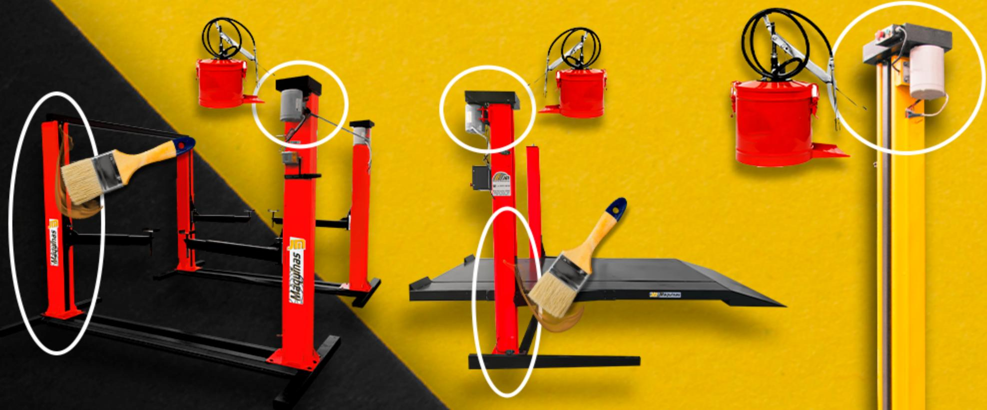
Não se esqueça da manutenção preventiva das demais máquinas! Lubrifique a cada **7 dias** com **graxa as colunas e o fuso**, lembre-se que a lubrificação do **rolamento superior** é feita com uso de uma **bomba engraxadeira**. **Utilize sempre graxa de boa qualidade.** Dessa forma você garantirá a segurança e prolongará a vida útil de sua máquina.
