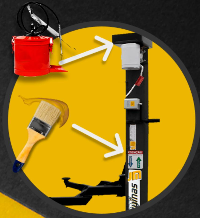
Para a segurança do operador, qualidade e vida útil da máquina, mesmo nos elevadores lubrificados a óleo, **complemente a lubrificação** também com **graxa** a cada **15 a 20 dias** nas **laterais onde correm as roldanas e no rolamento superior** (para engraxar o rolamento superior, utilize uma bomba engraxadeira).
