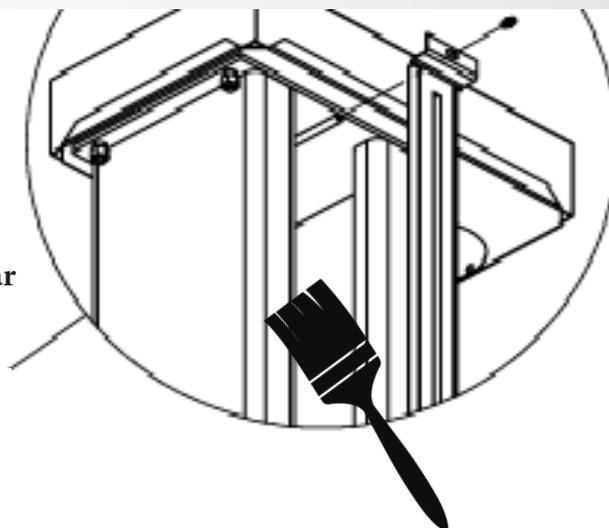
A lubrificação à graxa deve ser realizada periodicamente, semanalmente ou a cada 10 dias (a depender do uso). Lubrifique com graxa o **fuso, as laterais da coluna e os rolamentos (superior e inferior)**.
