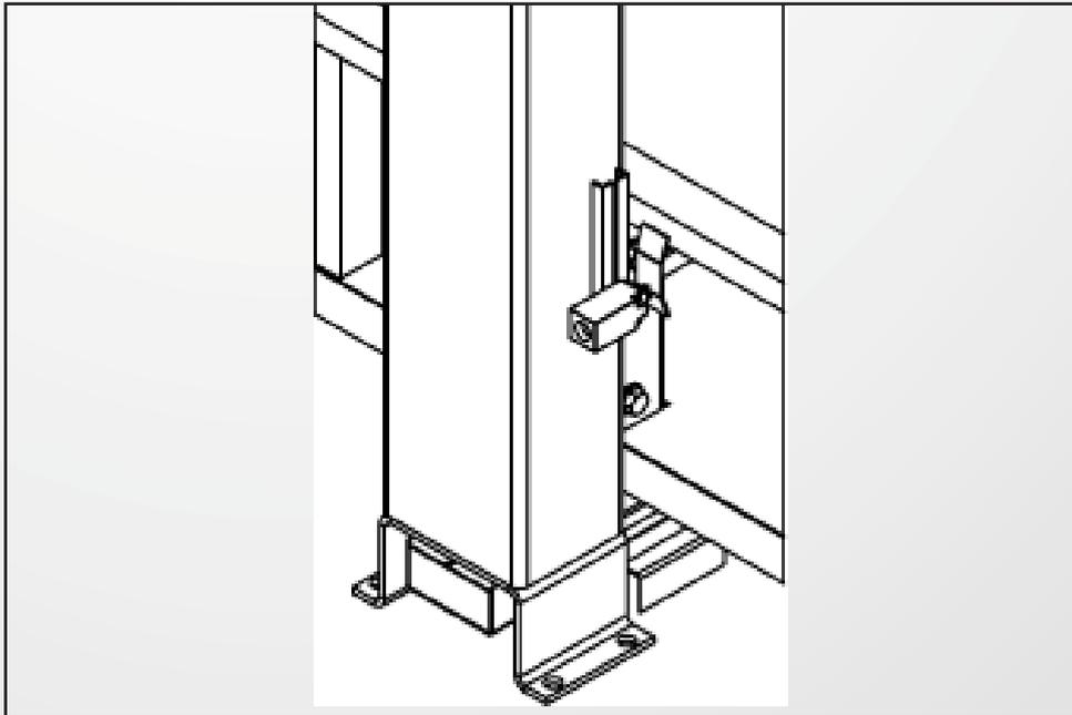
A fixação superior deve ser realizada por conta do próprio cliente, pelo fato de que cada local tem uma característica estrutural diferente, recomenda-se apenas que a fixação seja acompanhada por um profissional especializado, e que seja construída próximo do nível em que a plataforma irá parar não gerando tendência ao tombamento.
