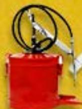
Lubrifique com graxa toda **lateral por onde correm as roldanas e fuso**. Para lubrificar o **rolamento superior**, utilize **bomba engraxadeira**.
