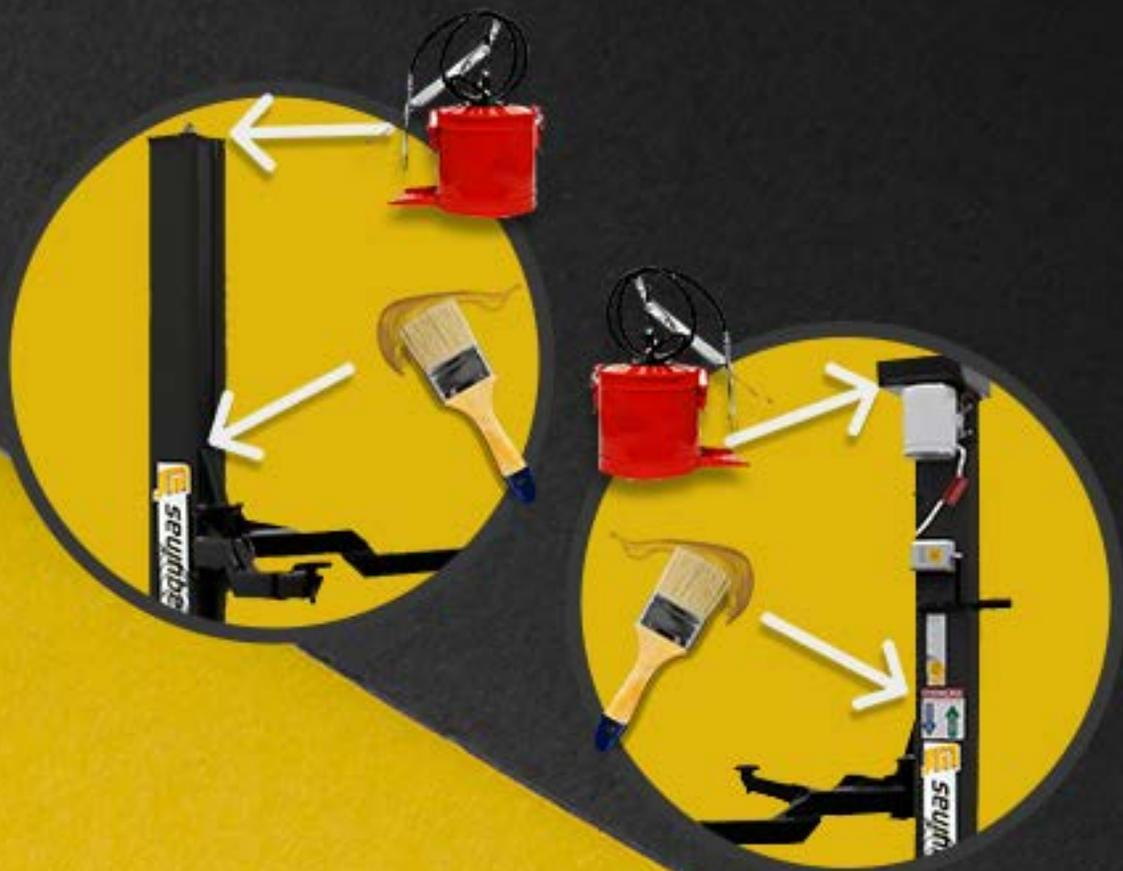
Para a segurança do operador, qualidade e vida útil da máquina, mesmo nos elevadores lubrificados a óleo, **complemente a lubrificação** também com **graxa** a cada **15 a 20 dias** nas **laterais onde correm as roldanas e no rolamento superior** (para engraxar o rolamento superior, utilize uma bomba engraxadeira).
