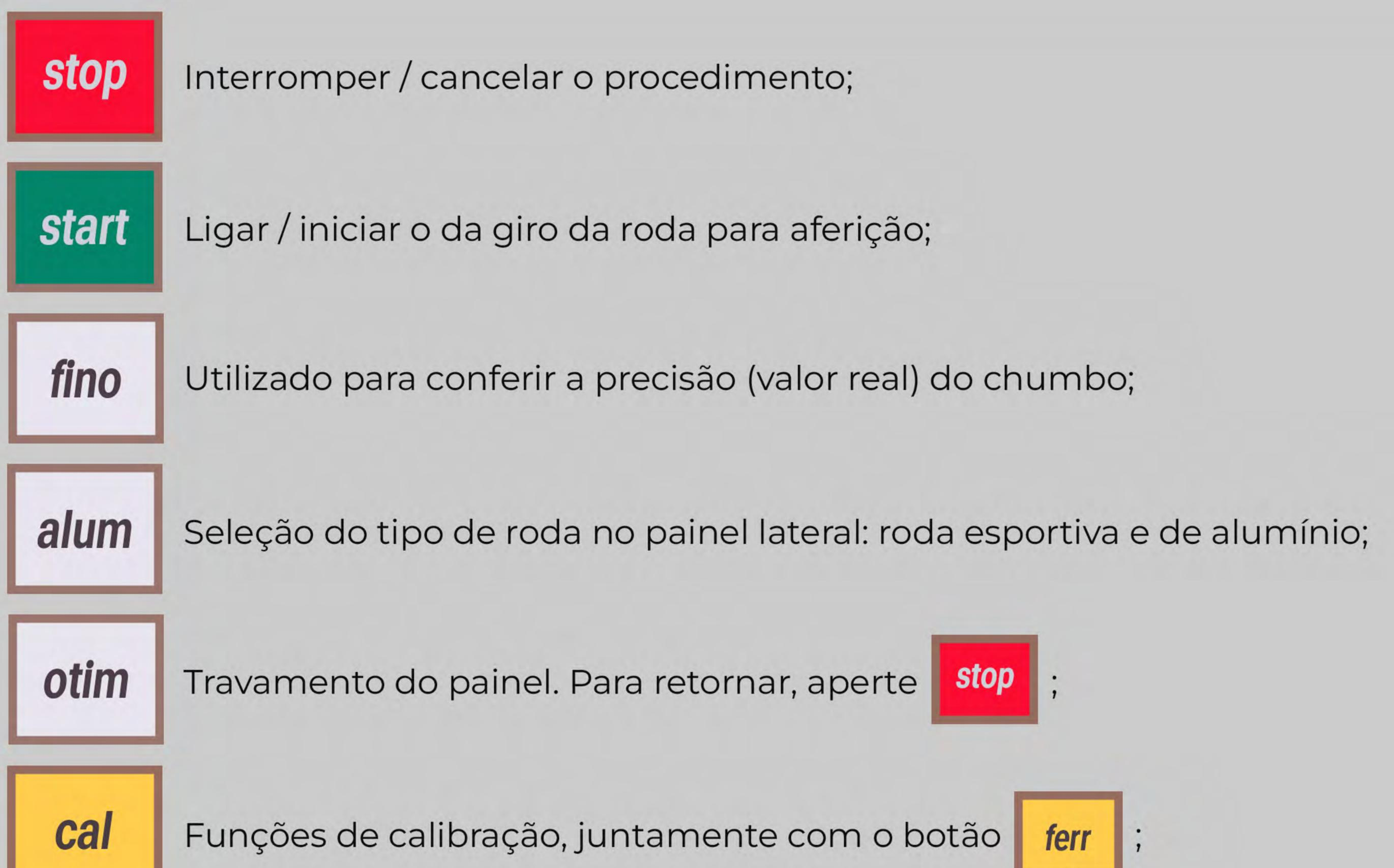
Aperte alum para selecionar o perfil de roda para balanceamento:
