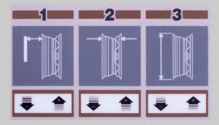
A balanceadora possui **três etapas** para inserção de medidas para efetuar o balanceamento da roda com precisão. Cada etapa é bem descrita através das ilustrações no painel, observadas na figura acima. Para **ativar** cada uma das três etapas, basta apertar o botão "**Baixo**" ou "**Cima**" referente a coluna da etapa que será inserida o valor.
