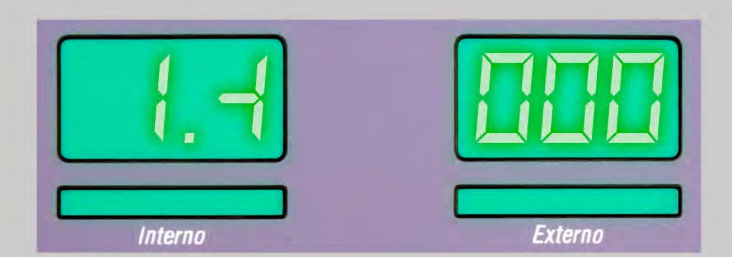
7) Mais uma vez aperte "Cima" na <u>coluna n° 1</u> (igual no passo 5) para configurar o próximo parâmetro. Dentro do parâmetro "S", mantenha o padrão 330. Caso não esteja já configurado, coloque em 330.
