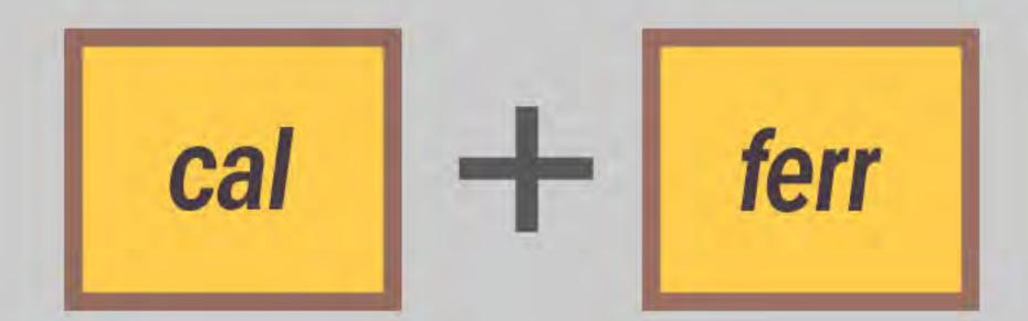
2) Mantenha pressionado os botões CAL e FERR até que os leds parem de piscar. Os visores do painel deverão aparecer " CAL CAL ".
