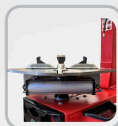
Mesa pneumática - sentido horário e anti horário.
