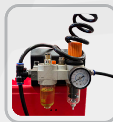
Filtro regulador e lubrificador instalado.
