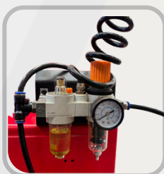
Filtro regulador e lubrificador instalado.
