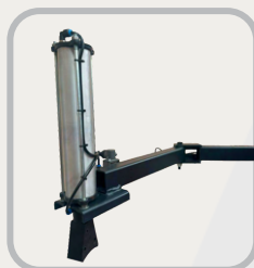
Braço auxiliar articulado pneumático.
