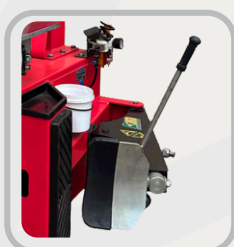
Descolador pneumático auxiliar lateral.
