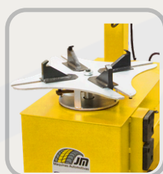
Mesa reforçada com quatro garras ajustáveis.
