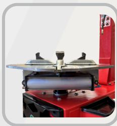
Mesa pneumática - sentido horário e anti horário.
