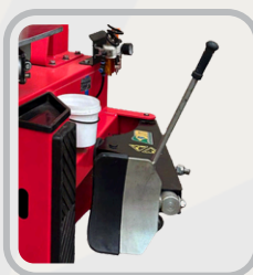
Descolador pneumático auxiliar lateral.
