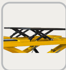
2 Macacos hidráulico tesoura até 2.000 Kg;
