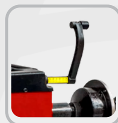
Régua de medição de largura do Pneu.
