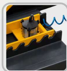
Trava de segurança eletropneumática.
