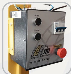
Caixa de comando com botão sobe/desce e botão para parada de emergência.
