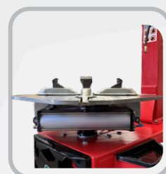
Mesa pneumática - sentido horário e anti horário.
