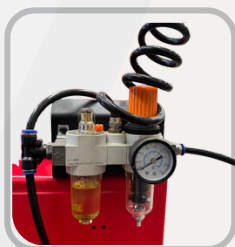
Filtro regulador e lubrificador instalado.
