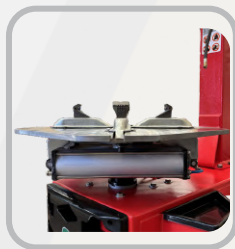
Mesa pneumática - sentido horário e anti horário.
