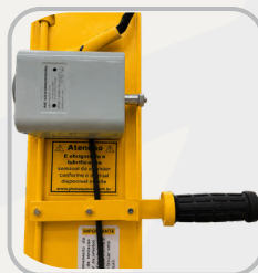
Alavanca de chave reversora.
