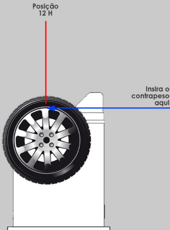
**4)** Após inserir o contrapeso, **repita o mesmo procedimento para o lado INTERNO da roda**, ou seja, movimente lentamente a roda com as mãos até que **todos** os leds se acendam no visor referente ao lado **INTERNO**.
