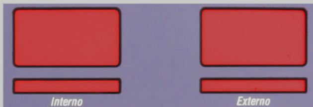
Após o processo de rotação da roda, observe nos visores as indicações numéricas. A numeração **00 00** indica que a roda está balanceada. Qualquer numeração diferente de "zero" significa desbalanceamento.
