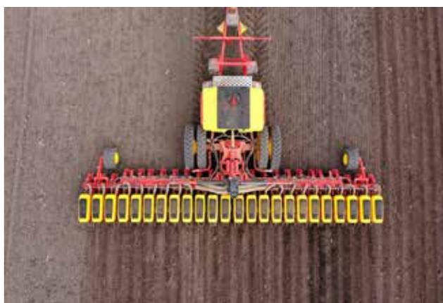
*Está disponível um reservatório de 3000 litros para fertilizante granulado como complemento à tremonha de 5000 litros nos modelos de capacidade superior. Além disso, o Tempo L pode ser equipado com uma tremonha de 2000 litros para fertilizantes líquidos.*
