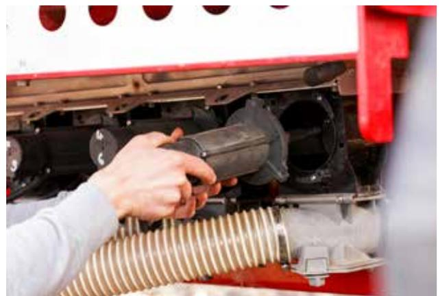
*O adubo é medido através do sistema de medição de alta capacidade, Fenix III, com uma capacidade de até 350kg/ha a 15km/h.*
