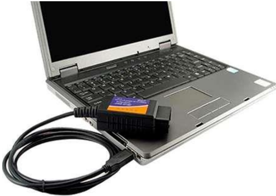
Figura 5. Una interfaz ELM-327 se usa para comunicarse con un vehículo a través de un PC
