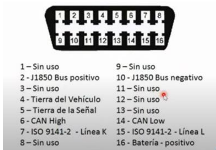
Figura 4. Los diferentes protocolos de comunicación OBD2 y los pines asignados en el conector DLC.
