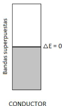
La conducción en los metales se ve condicionada por una resistencia eléctrica, causada por los choques de los electrones con los iones positivos de la red, los cuales tienen energía cinética que aumenta con la temperatura.
