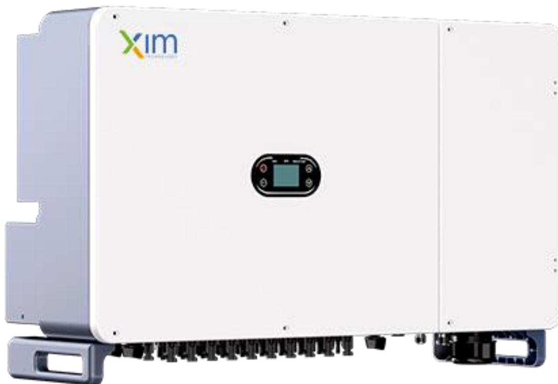
El inversor trifásico conectado a la red XG100 - 136KTR puede aplicarse de manera flexible a diversas plantas fotovoltaicas comerciales e industriales de mediana y gran escala. Es compatible con módulos de 700W y superiores. Para aumentar la generación de energía del sistema, admite recuperación PID nocturna. Además, cuenta con una protección IP66 de alto nivel, lo que lo hace adecuado para entornos exteriores exigentes.
