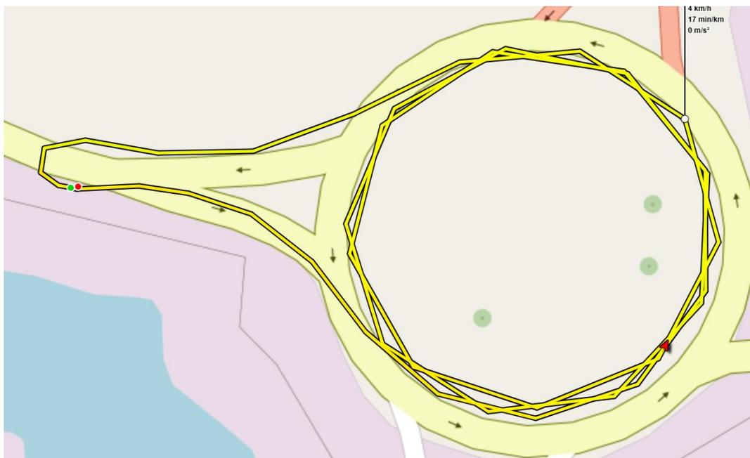
Figure 13 : La fréquence d'acquisition insuffisante présente un trajet saccadé
