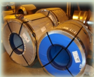
LOTE DE BOBINAS DE AÇO GALVANIZADO sinistradas no transporte de importação,
