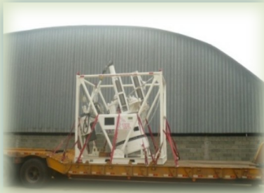
FERRAMENTA DE INSTALAÇÃO E REENTRADA DA BAP - FIBAP danificada no transporte
