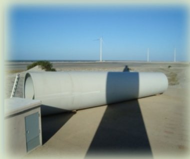
TORRE 04 DE SUSTENTAÇÃO DE UM AEROGERADOR danificada durante o transporte
