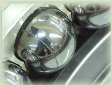
MOTOR GE CF6-80-C2-B2 sinistrado na importação, sem os "Shock Absorbers" Foto: esferas dos rolamentos "marteladas"
