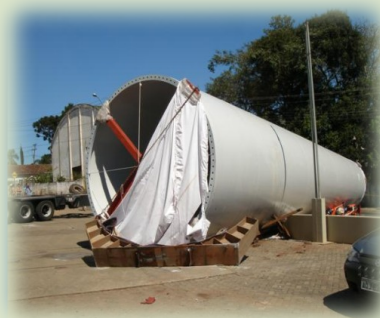
TORRE 05 DE SUSTENTAÇÃO DE UM AEROGERADOR danificada após a queda
