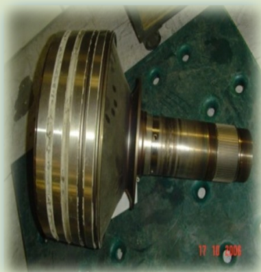
MOTOR GE CF6-50, Componente "SPOOL SHAFT" acidentado em serviço de retrabalho
