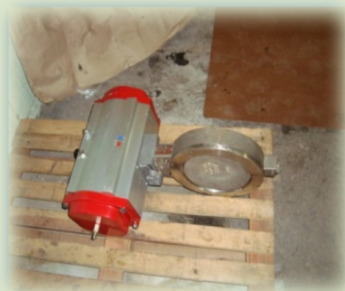
72 VÁLVULAS BRAY COM ATUADORES INDUSTRIAIS danificadas durante acidente
