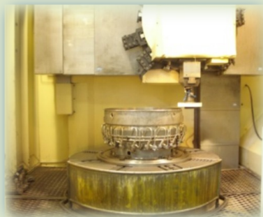
MOTOR CFM56-3B1 COMPONENTE "COMBUSTION CASE" acidentado em serviço de retrabalho
