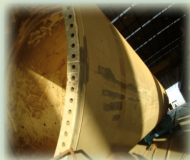
TORRE 02 DE SUSTENTAÇÃO DE UM AEROGERADOR danificada durante o transporte
