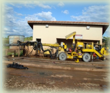
MÁQUINA PERFURATRIZ JUMBO ROCKET BOOMER 104 sinistrada em operação escavação da mina
