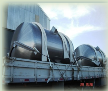
DOIS TANQUES MISTURADORES EM AÇO INOX de 6 ton. "Shampoo", danificados no transporte
