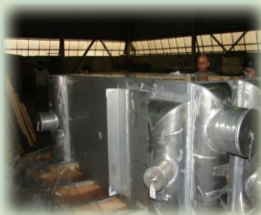
TROCADOR DE CALOR REVERSÍVEL DE ALUMÍNIO SR071 SUMITOMO sinistrado na importação
