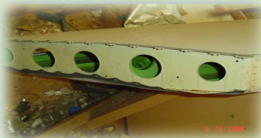
ESTABILIZADOR HORIZONTAL sinistrado, aeronave EMB-170
