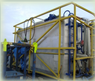
TANQUE DE AFERIÇÃO FGTS-C INT-2005-006 sinistrado no transporte
