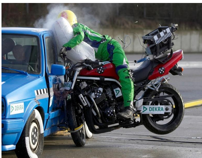
Figura 4.1 – Crash test com manequins antropométricos e airbag para motociclistas. Estes não fazem parte da nova Resolução do CONTRAN. Fonte: DEKRA.
