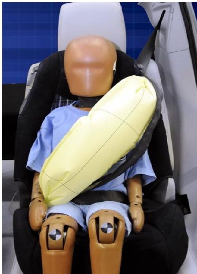
Figura 3: Cintos infláveis. Inovações para proteção dos ocupantes em acidentes. Distribuem homogeneamente a força cinética em colisões. Fonte: Group VP, Sustainability, Environment & Safety Eng. Ford Motor Company.
