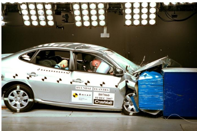
Figura 4 – Crash test com manequins antropométricos e airbag . Fonte: NHTSA.
