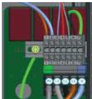
Figure 6 : Alimentation des bornes de raccordement et connecteur Control Pilot (CP) pour câble de charge (rouge) à Pro-line
