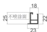
MQ-Y02 65玻璃附框 壁厚: 2.0 mm 米重: 0.44 kg/m
