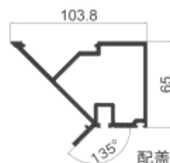
MQ-Y14 阴转角辅料 壁厚: 2.5 mm 米重: 2.46 kg/m
