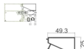
MQ-Y09 隐框收边 壁厚: 1.4 mm 米重: 0.53 kg/m
