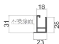
MQ-Y07 80玻璃附框 壁厚: 2.0 mm 米重: 0.51 kg/m
