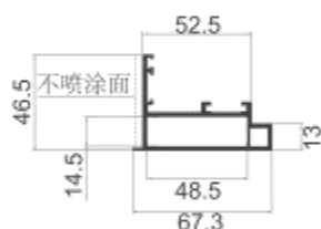
MQ-K04 明框开启扇 壁厚: 2.0 mm 米重: 1.17 kg/m
