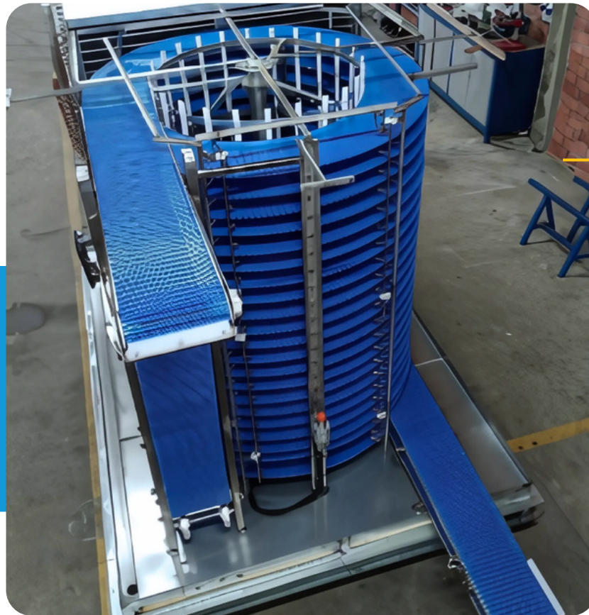
Túnel de congelamento
