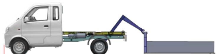
LONGITUD NECESARIA PARA CARGA/DESCARGA 7400 mm
