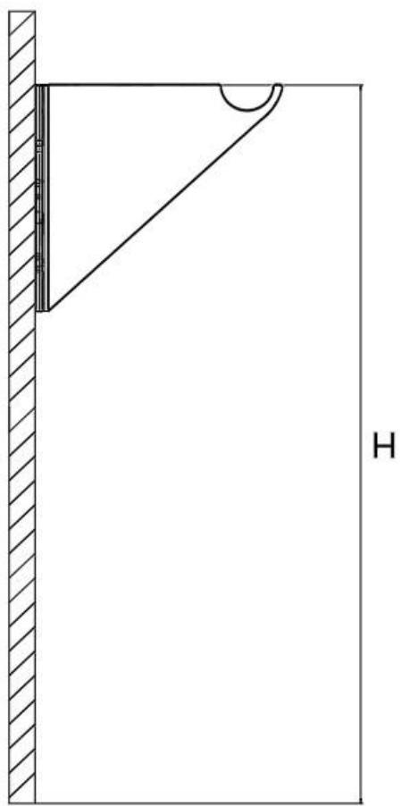
3. Marquez la hauteur souhaitée avec un niveau et un crayon et faites un trou aux points avec une perceuse et une mèche de 8 mm.
