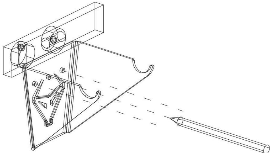
4. Insérez les chevilles dans les trous que vous venez de réaliser puis, en passant les vis dans les trous, vissez le support au mur.
